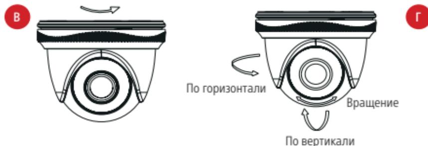
Рис. 2 Установка камеры FC12W|FC22W|FC52W на потолок
