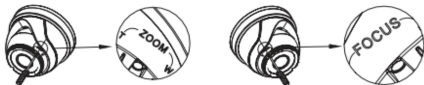
Рис. 5 Регулировка угла обзора камеры FC18W|FC28W|FC58WX
