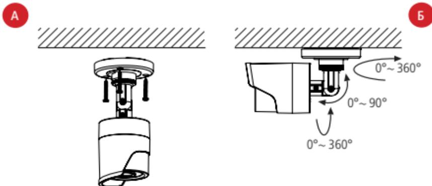
Рис. 3 Установка камеры FC13W|FC23W|FC53W на потолок
