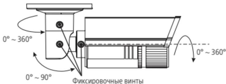
Рис. 6 Регулировка угла обзора камеры FC19W|FC29W|FC59WX
