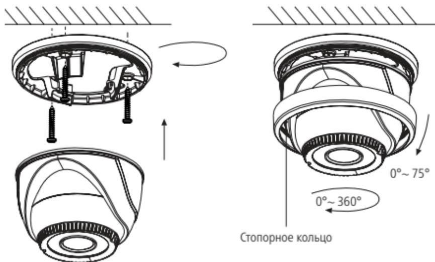
Рис. 4 Установка камеры FC18W|FC28W|FC58VX
