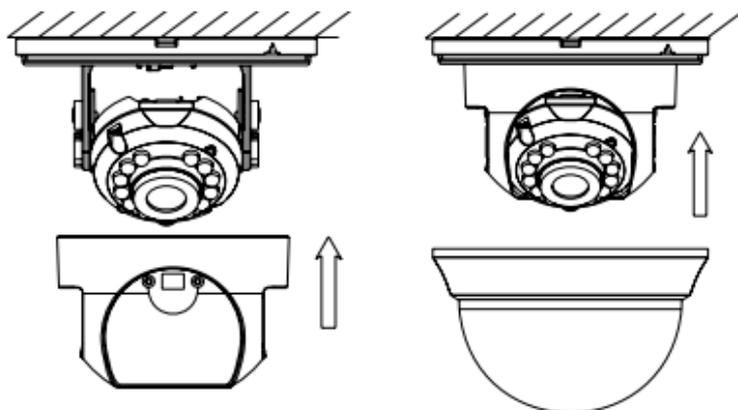
Рис. 1 Установка камеры FC11|FC11 Black|FC21 на потолок
