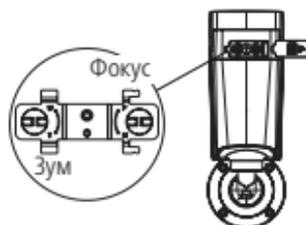
Рис. 7 Управление зумом и фокусом
