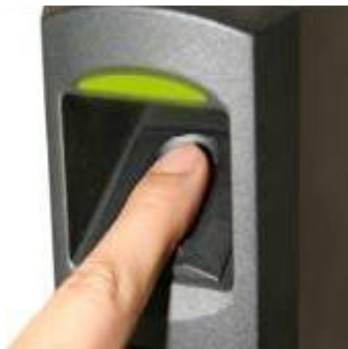
Рисунок 8. Правильное расположение пальца при сканировании
