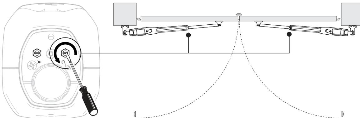
**Определение точек крепления кронштейнов**
