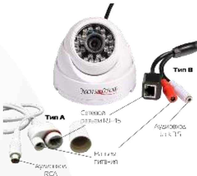
Распайка RCA разъёма для типа А
