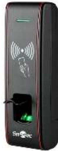
Биометрический считыватель ST-FR030EMW поддерживает идентификацию по отпечаткам пальцев и/или по проксимити картам стандарта EM и предназначен для использования в системах контроля доступа. Устройство имеет герметичный корпус и встроенный обогреватель с терmostатом, что позволяет использовать его в уличных условиях с температурой окружающей среды от -40°C до +50°C.
