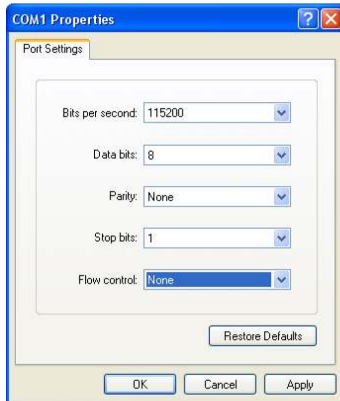
Fig. 3.3 Serial ports parameter setup
