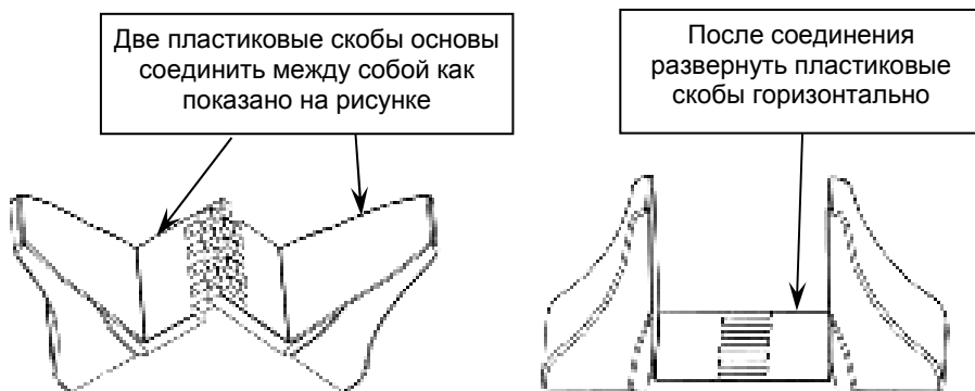
Рисунок 3 - Сборка пластиковых основ для вертикальной установки изделия.
