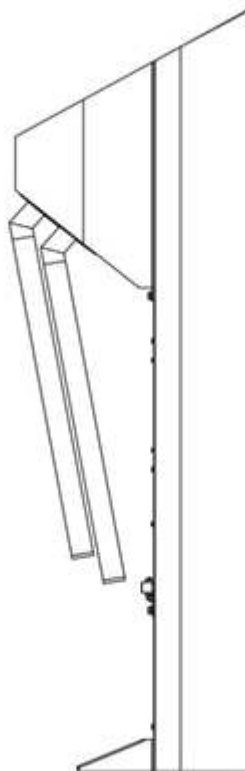
Рисунок 12 – Турникет со сложенными планками
