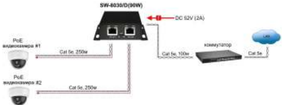
Рис.5 Схема подключения коммутатора/удлинителя SW-8030/D(90W) в режиме увеличения расстояния передачи данных и PoE (до 250м) и питанием от внешнего БП
