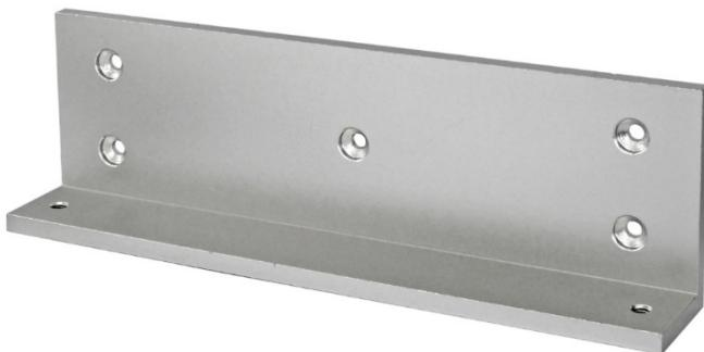
Кронштейн L типа выполнен из алюминия и предназначен для крепления электромагнитных замков на двери, открывающиеся наружу, когда ширина дверной коробки не допускает непосредственный монтаж замка.
