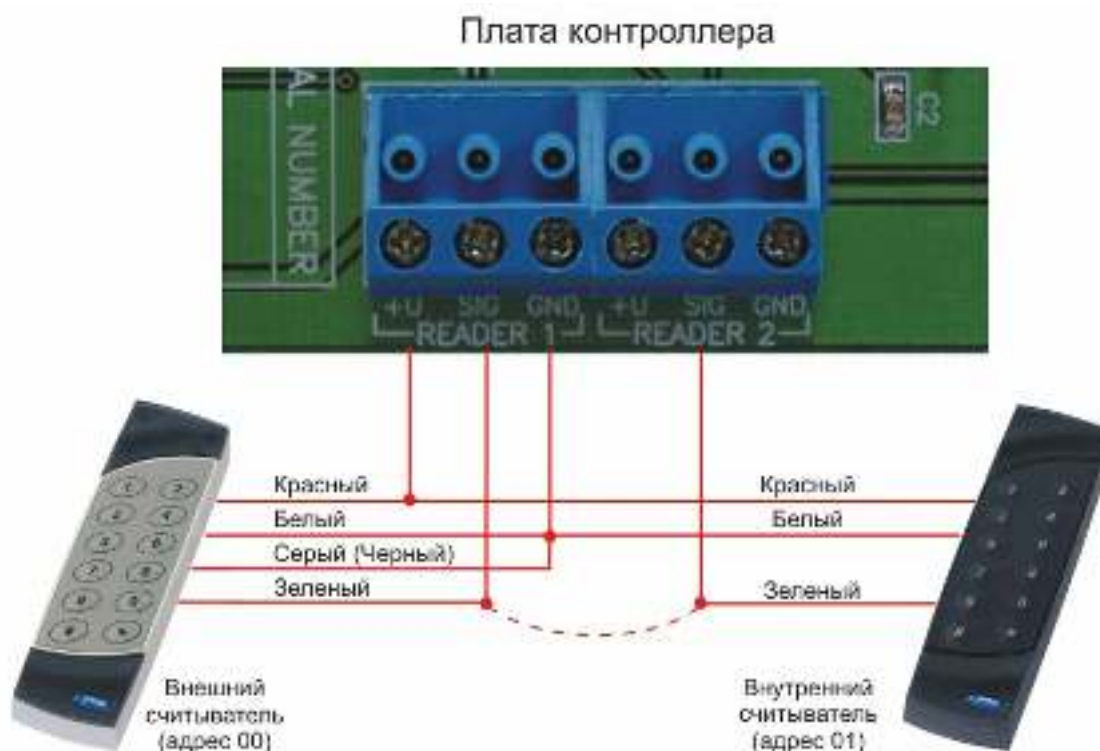
Рисунок 8а. Подключение считывателей серии NR-xxx к контроллерам NC-2000-IP.
