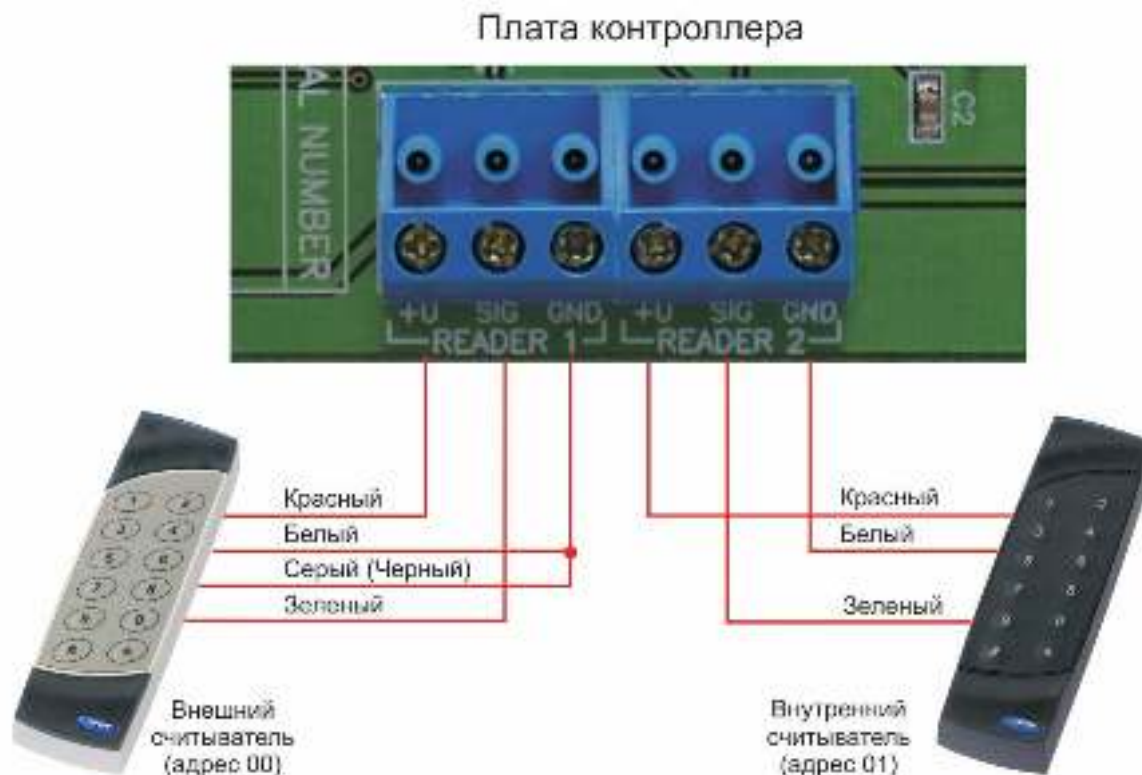
Рисунок 86. Подключение считывателей серии NR-xxx к контроллерам NC-2000-IP.
