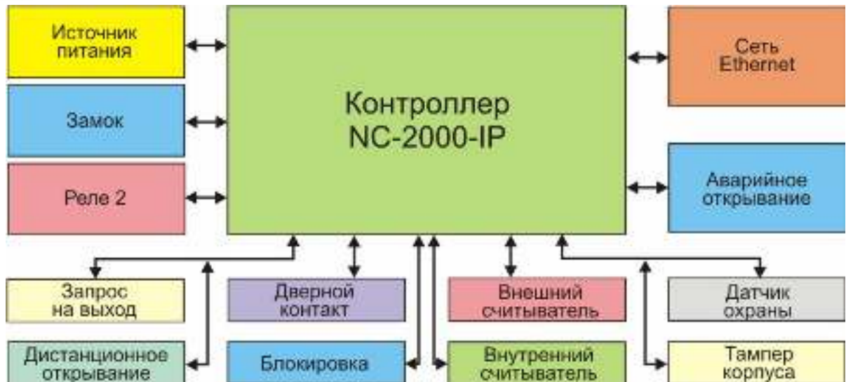
Рисунок 7. Оборудование, подключаемое к контроллеру NC-2000-IP.
