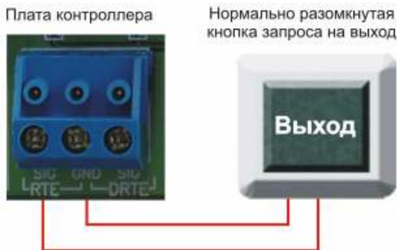
Рисунок 9. Схема подключения кнопки запроса на выход.
