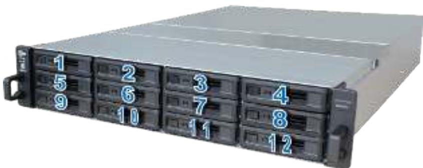
**Примечание.** Для создания тома RAID рекомендуется использовать диски одного размера, чтобы оптимизировать использование объема дисков.
