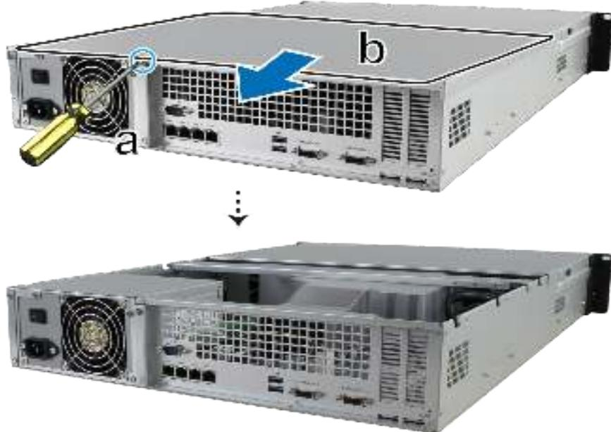
**a** Отвинтите винт на задней стороне RackStation.
