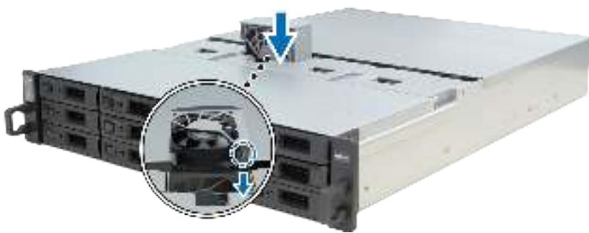
**6** Установите на место крышку вентилятора, снятую на шаге 2.
