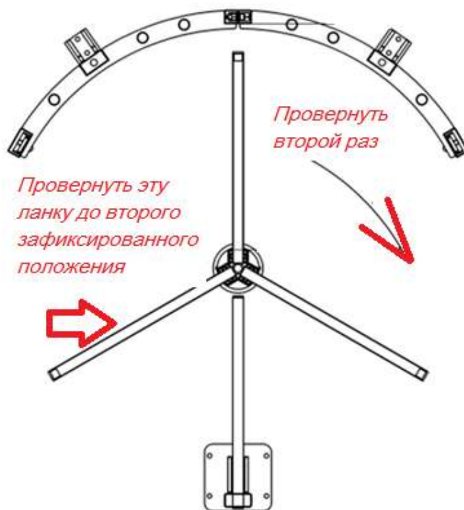
Рисунок 7 – Второй проворот ротора до следующего преграждающего положения
