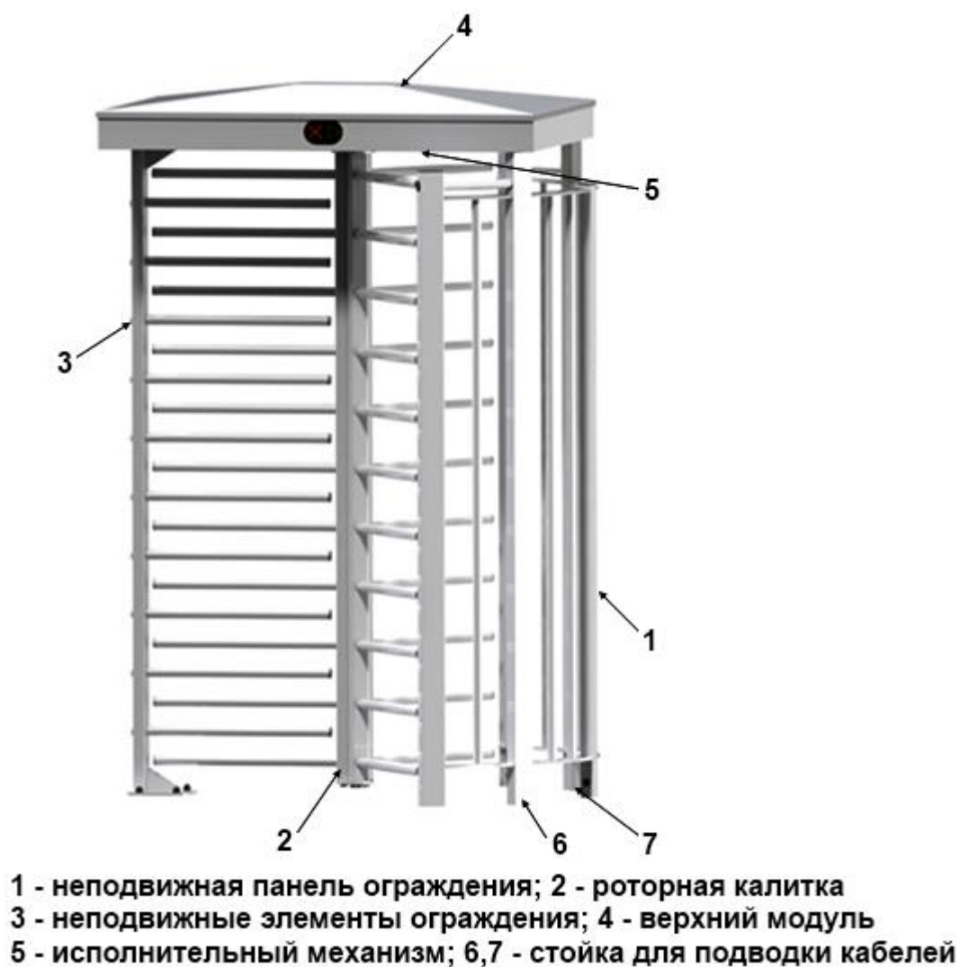
Рисунок 1 – Общий вид турникета
