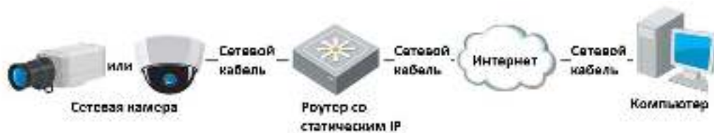
Рисунок 2-10 Доступ к видеокамере через роутер со статическим IP-адресом
