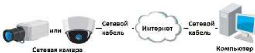
Рисунок 2-11 Доступ напрямую к видеокамере со статическим IP-адресом
