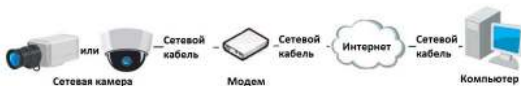
Рисунок 2-12 Доступ к видеокамере с динамическим IP-адресом
