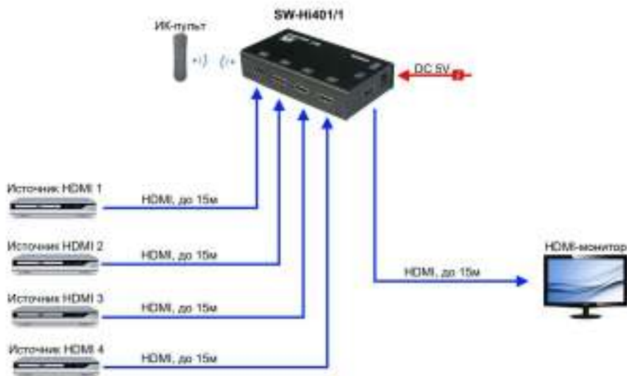
Рис.5 Типовая схема подключения коммутатора HDMI SW-Hi401/1
