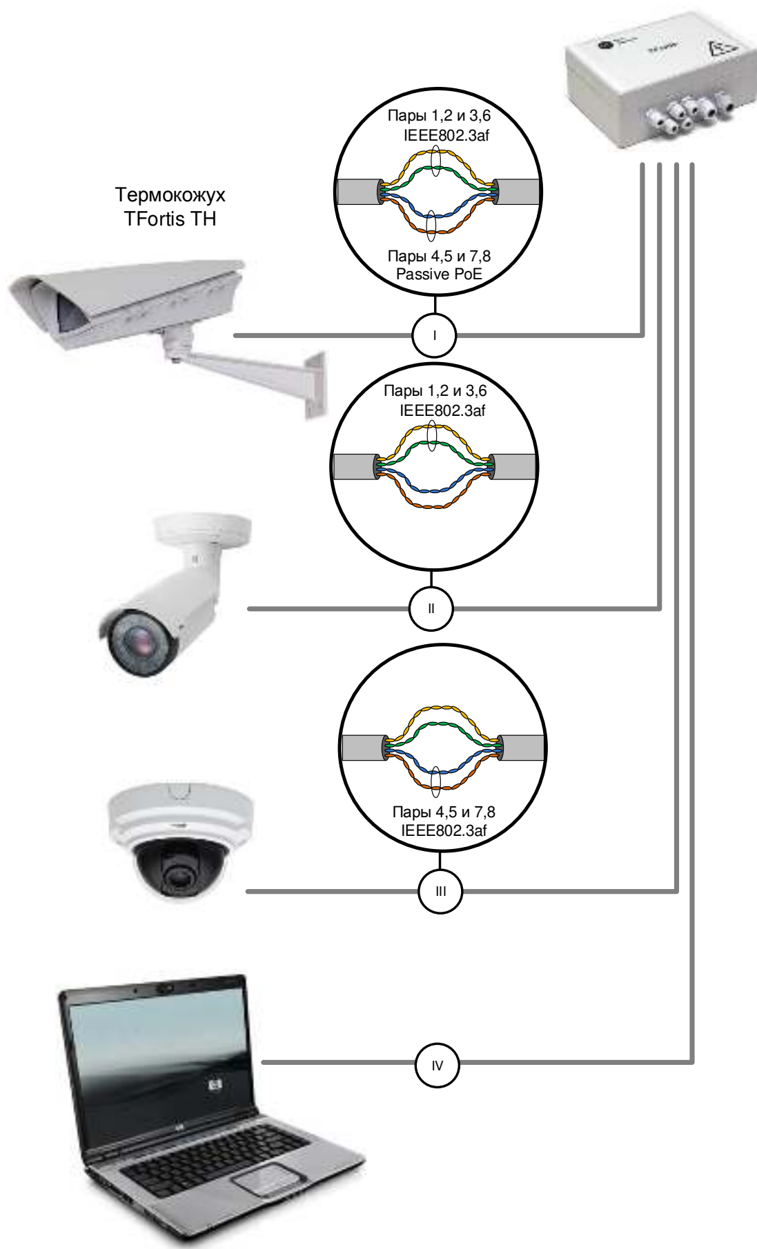
Рис. 2.3. Схема питания по PoE для разных случаев
