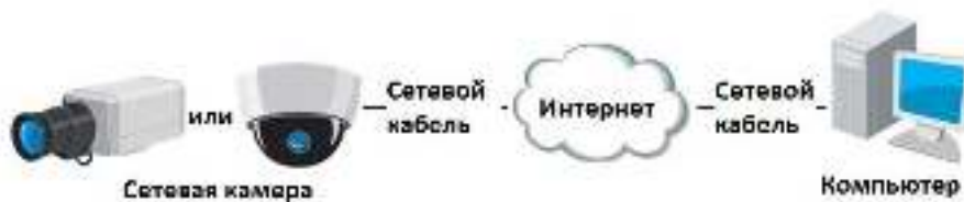
Рисунок 2-11 Доступ напрямую к видеокамере со статическим IP-адресом
