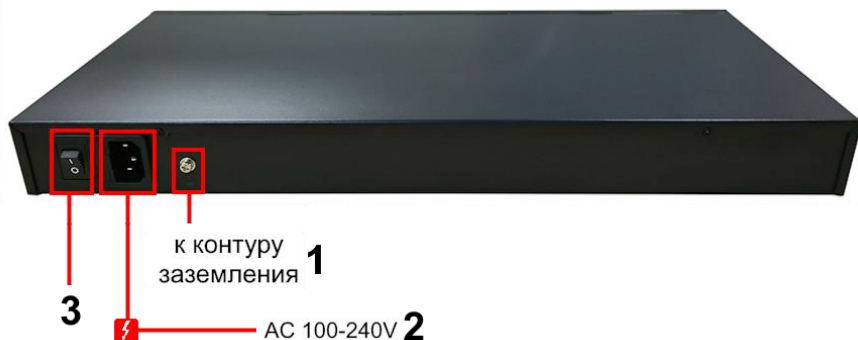
Рис.5 Подключение коммутатора к сети переменного тока AC 220V
