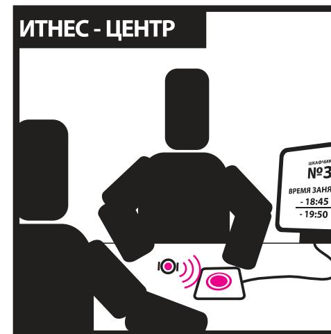
**6** При выходе из спортклуба, клиент подносит браслет к считывателю Z-2USB подключенному к компьютеру и программе “управление шкафчиками”. Программа выводит общее время пребывания клиента в спорт клубе и фиксирует, что шкафчик свободен.
