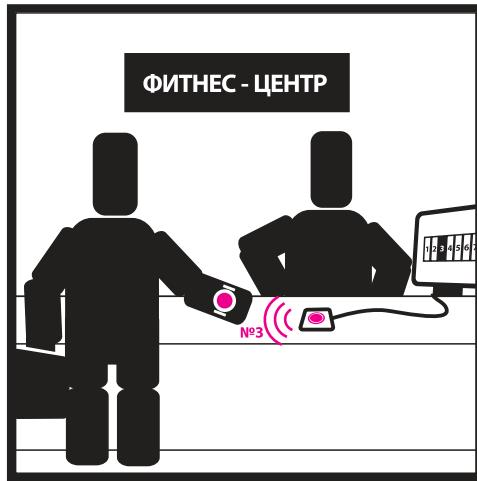
**2** Перед тем как выдать браслет, администратор подносит его к считывателю Z-2USB подключенному к компьютеру и программе “управление шкафчиками”. С помощью программы администратор назначает какой номер(а) шкафчика(ов) этот браслет может открыть. Компьютер делает отметку в программе “управление шкафчиками”, что этот шкафчик занят.
