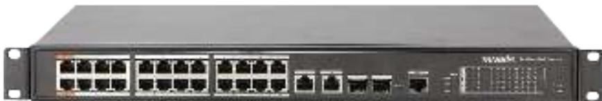
**TRASSIR TR-NS22xx** – управляемый коммутатор с 16/24 PoE портами 10/100 Мбит/сек с возможностью подачи питания к подключенным устройствам по витой паре.
