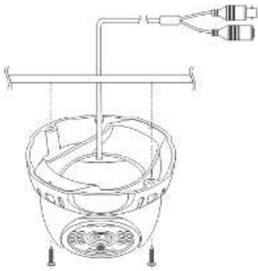
Приклейте монтажный шаблон в место, где планируется установка камеры. Основание купола крепится к поверхности четырьмя винтами #10, которые поставляются в комплекте, через четыре отверстия в
