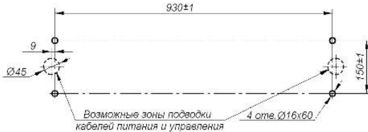
Рисунок 10. Схема разметки отверстий для крепления стойки турникета
