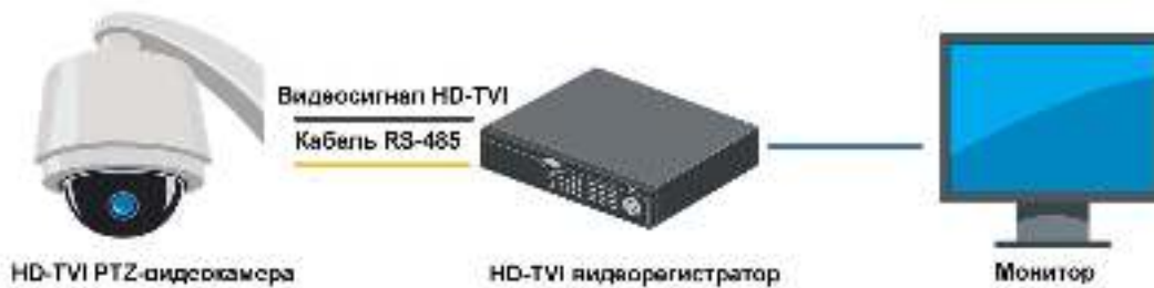
Рис. 2.3. Типичная схема управления через видеорегистратор
