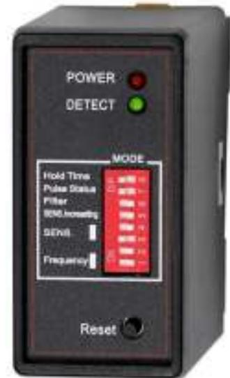
Индукционный одноканальный датчик ST-RB001LD предназначенный для обнаружения транспортных средств для обеспечения безопасности или автоматизации проезда. При обнаружении транспортного средства, проезжающего над индукционной петлей, контроллер датчика включает выходное реле.
