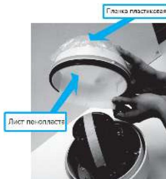
4. Снимите ленту и крышку объектива
