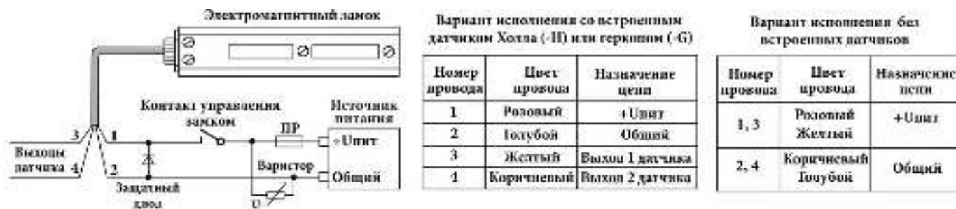
Рисунок 9 - Схема подключения замка
