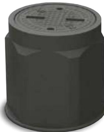
Используется в качестве стандартного смотрового устройства с выводом люка на поверхность, при заложении трубопроводов на глубину 350 мм. Имеет 6 монтажных площадок, размером 350x185 мм для осуществления вводов труб с различных направлений под углом 180°, 120°, 90° и 60°. Позволяет разместить малогабаритные кабельные муфты и запас кабеля с допустимым радиусом изгиба до 180 мм.
