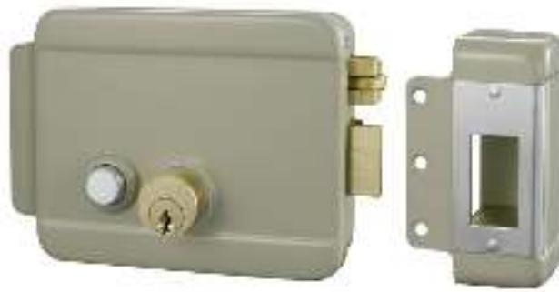
Замок ST-RL073DI-GR предназначен для запирания дверей, калиток, ворот и может применяться совместно с системами контроля доступа (контроллеры, домофоны, кодовые панели). Управление замком осуществляется электрическим или механическим способом. Для удаленной разблокировки ST-RL073DI-GR необходима кратковременная подача напряжения. Замок можно открыть ключом снаружи или кнопкой изнутри, кроме того, его можно заблокировать ключом с внутренней стороны.
