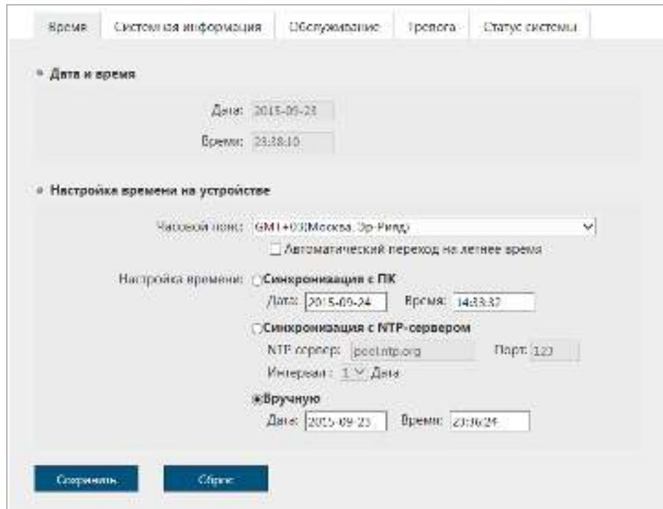
В блоке **Дата и время [Date & Time]** отображаются дата и время установленные на IP-камере.
