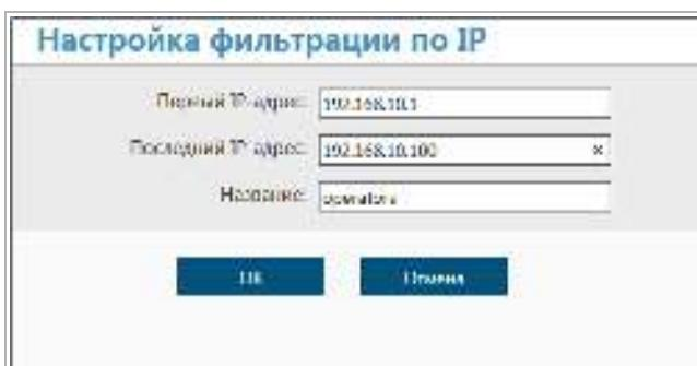
В открывшемся окне **Настройка фильтрации по IP [IP Filtering Settings]** введите **Первый IP-адрес [Start IP]** диапазона и **Последний IP-адрес [End IP]**. В поле **Название [Alias]** введите название данного диапазона IP-адресов.
