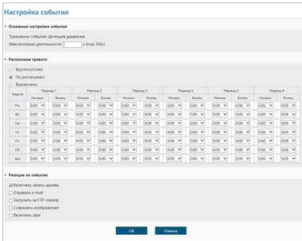
В блоке **Основные настройки события [General]** указывается тип настраиваемого события. В поле **Мин. интервал длительности [Min. interval of trigger event]** установите время, по которому будет определяться наступление события. То есть, если тревожное событие длится меньше указанного времени, то оно считается не наступившим.
