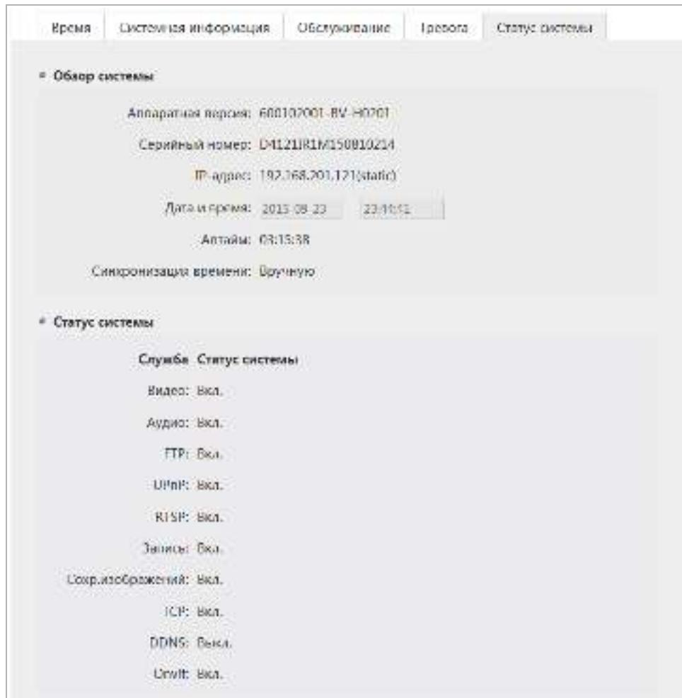
В блоке **Обзор системы [System Overview]** отображается системная информация и значение некоторых настроек IP-камеры.
