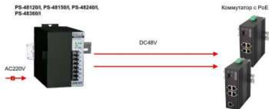
Рис. 8 Подключение PS-48120/I, PS-48150/I, PS-48240/I, PS-48360/I
