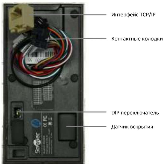
**Контактные колодки** используются для подключения замка, кнопки выхода, дверного датчика, источника питания, внешнего считывателя и линии связи RS485
