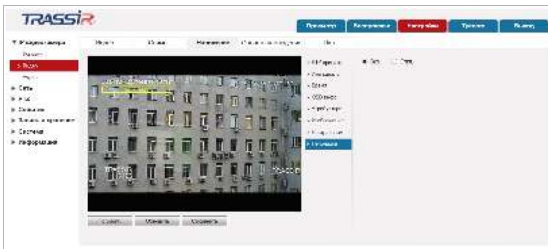
Чтобы включить на видео отображение сообщений о неполадках, установите флаг **Вкл. [Enable]**, установите флаг **Откл. [Disable]** чтобы отключить.
