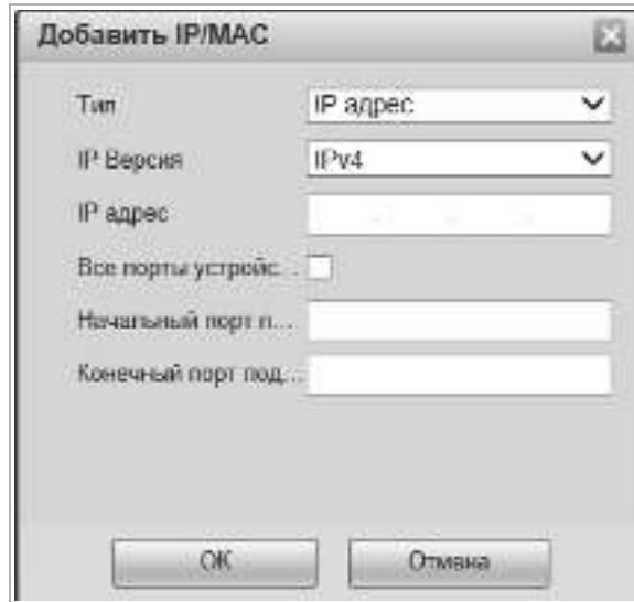
Если вы хотите включить в список только один IP адрес, выберите его в поле *Тип [Rule Type]*, в поле *IP версия [IP Version]* выберите версию IP – *Ipv4* или *Ipv6* и в поле ниже введите адрес.
