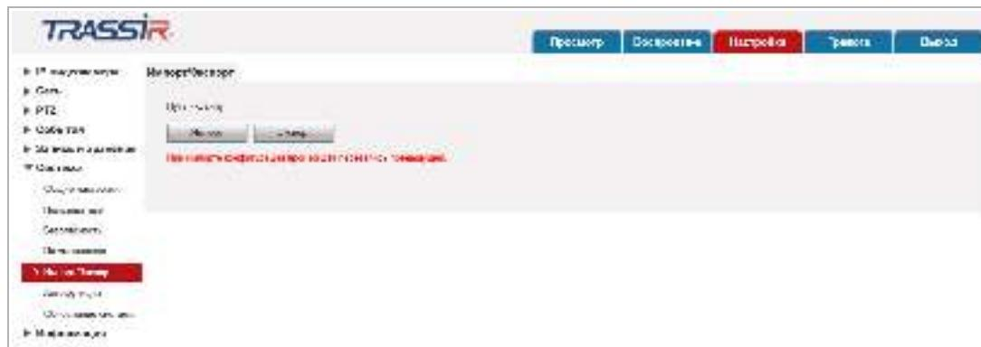
При нажатии на кнопку **Импорт [Import]** откроется диалог выбора файла с ранее сохраненной конфигурации настроек IP-камеры. После выбора файла произойдет загрузка, текущие настройки при этом будут заменены.
