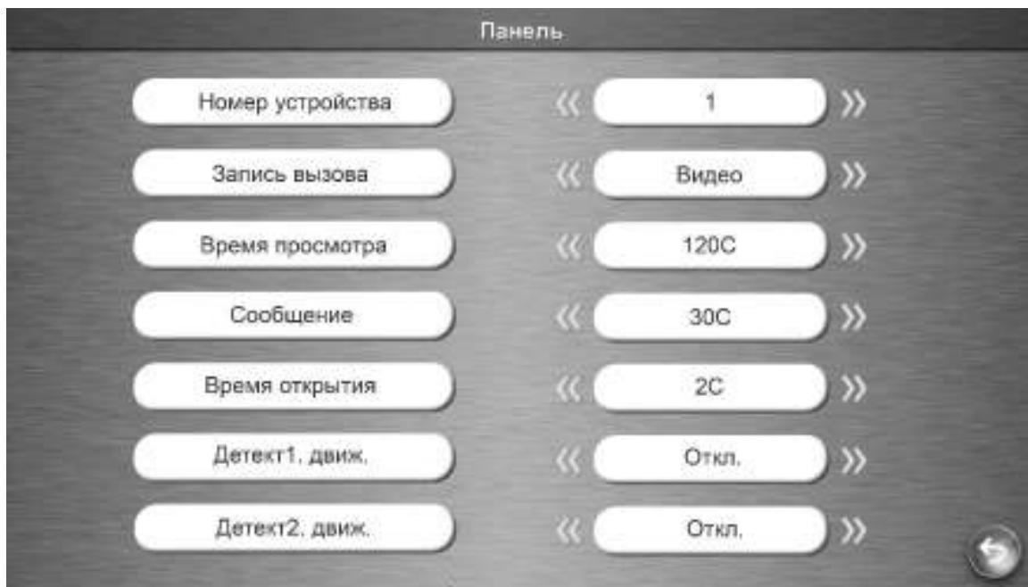
**Номер устройства** – при подключении нескольких мониторов по интеркуму необходимо установить адрес устройства: 1 – основной монитор, 2 – 6 – дополнительные мониторы (см. ВОЗМОЖНОСТИ ПОДКЛЮЧЕНИЯ).
