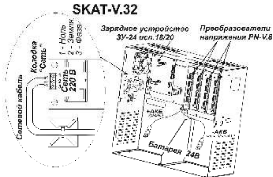
Рисунок 1 - Внешний вид блока с открытой крышкой и подключение сетевых проводов и провода заземления
