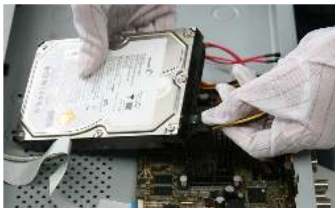
Рисунок 2.3 Подключение кабеля питания
