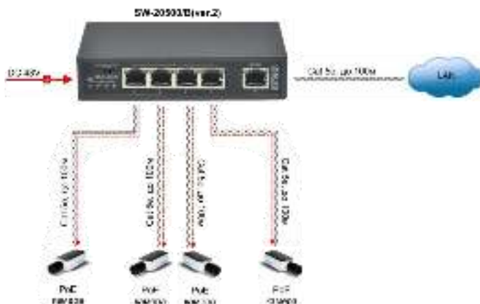
Рис.4 Типовая схема подключения коммутатора SW-20500/B(ver.2)
