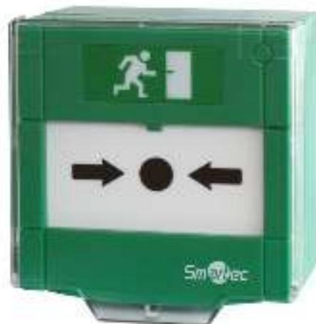
Устройство разблокировки дверей (УРД) ST-ER115 рекомендуется к использованию для разблокировки электрически управляемых замков в экстренных случаях с внутренней стороны на выход, например, при эвакуации людей. Устройство комплектуется пластиковой восстанавливаемой вставкой, что позволяет быстро и без дополнительных расходов восстановить нормальный режим эксплуатации дверей после осуществления эвакуации.
