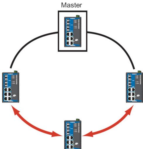
Если в кольце четное количество устройств EDS ( $2N$  EDS), то резервный сегмент – это один из двух сегментов, подсоединенный к устройству EDS  $N+1$  (коммутатору, наиболее удаленному от «мастера сети»).
