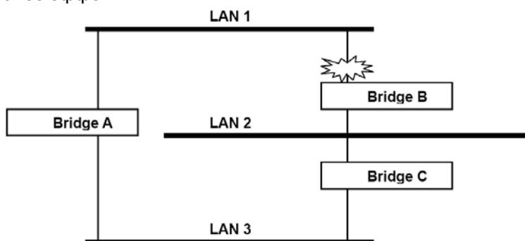
Что произойдет при сбое линии? Как показано на рисунке, механизм STP произведет автоматическое переконфигурирование сети, так чтобы трафик из LAN2 проходил через мост B.
