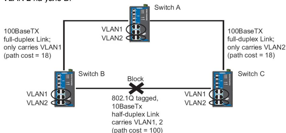
Чтобы избежать этого разделения, все соединения между коммутаторами должны быть сделаны членами всех возможных виртуальных сетей 802.1Q VLAN. Это позволит гарантировать возможность связи в любое время. К примеру, для обеспечения стабильной связи все соединения между мостами А и В и между А и С должны работать по протоколу 802.1Q и пропускать данные сетей VLAN1 и 2.
