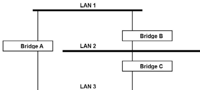
Если механизм STP активирован, он обнаружит параллельные пути и заблокирует один из них от передачи трафика. В примере показано, как STP определил, что трафик из LAN 2 в LAN1 должен проходить через мост C и A, поскольку у этого пути большая пропускная способность, а значит, он более эффективный.
