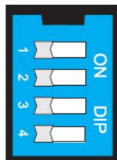
DIP-переключатели, расположенные на верхней панели коммутатора, позволяют построить сеть Turbo Ring в считанные секунды. При необходимости, для избежания случайного изменения конфигурации сети обслуживающим персоналом, эти переключатели могут быть программно отключены. Для отключения DIP-переключателей выберите в меню управления коммутатором раздел Basic Settings, параметр Turbo Ring DIP Switches. Затем в появившейся странице установите флаг Disable the Turbo Ring DIP Switch.
