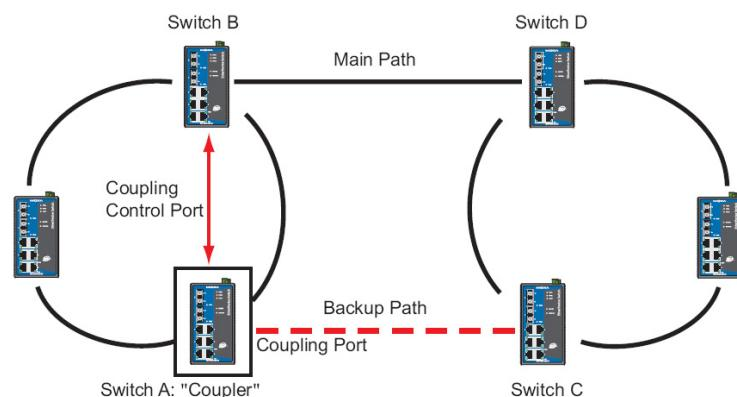
Для настройки Ring Coupling выберите два коммутатора EDS в одном кольце (например, коммутаторы А и В на приведенном рисунке) и два коммутатора в другом кольце (например, коммутаторы С и D).
