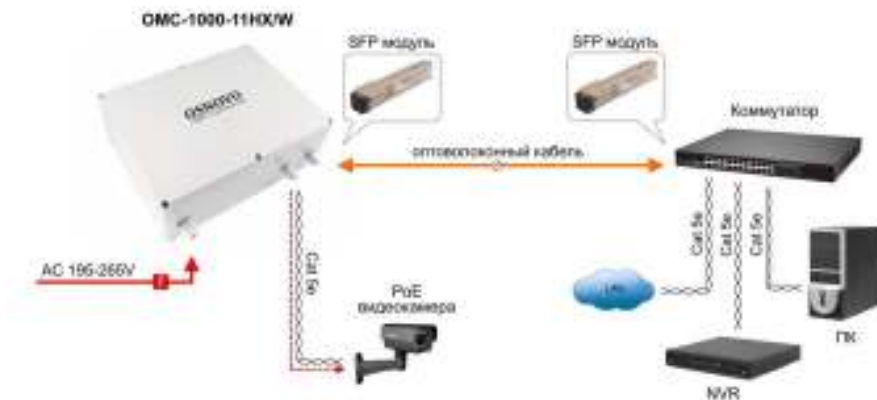
Рис.6 Типовая схема подключения медиаконвертера OMC-1000-11HX/W
