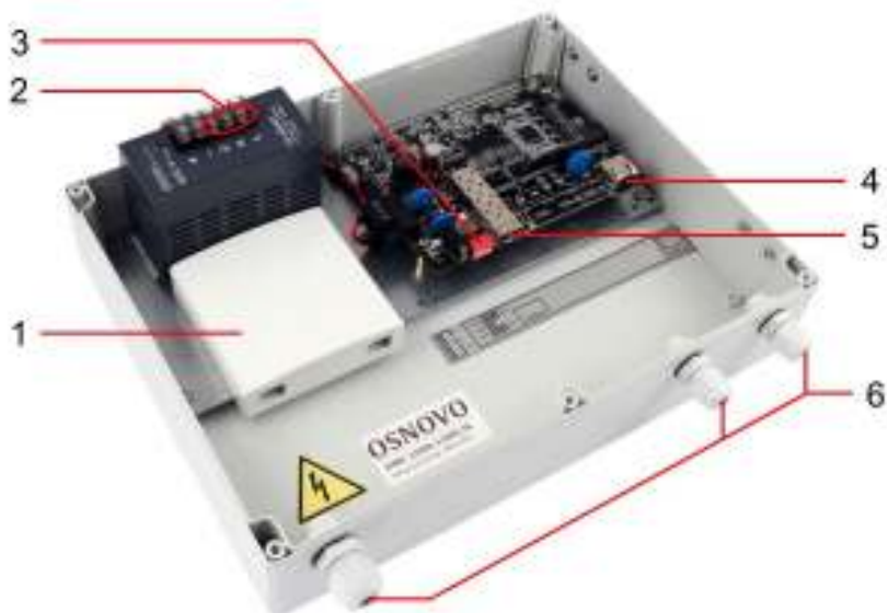
Рис. 2 Медиаконвертер OMC-1000-11HX/W, вид внутри
