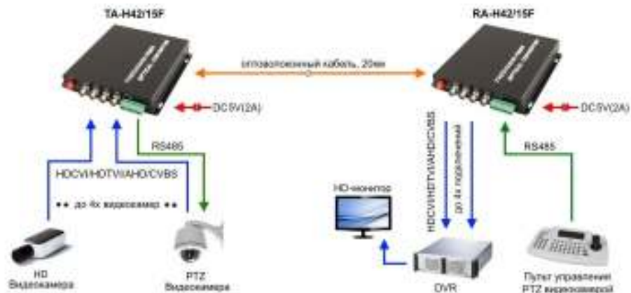
Рис.5 Типовая схема подключения передатчика TA-H42/15F и приемника RA-H42/15F
