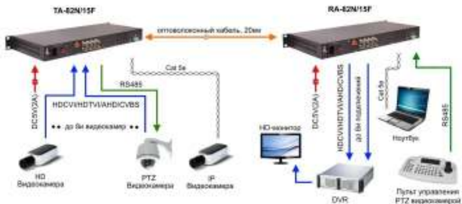
Рис.6 Типовая схема подключения передатчика TA-H82N/15F и приемника RA-H82N/15F
