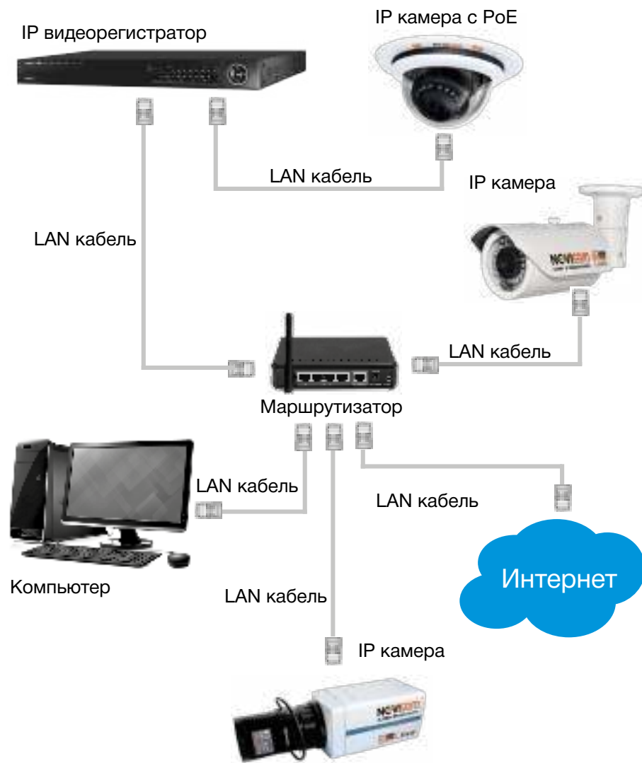
Рисунок 3.19 Подключение IP видеорегистратора с PoE.
