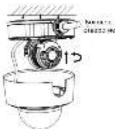
Рисунок 2-3 Прокладка кабеля через боковое отверстие
