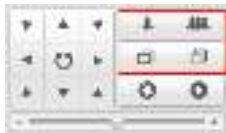
Рисунок 2-11 Настройка увеличения/фокуса на панели PTZ управления
