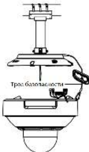
Рисунок 2-19 Закрепление троса безопасности
