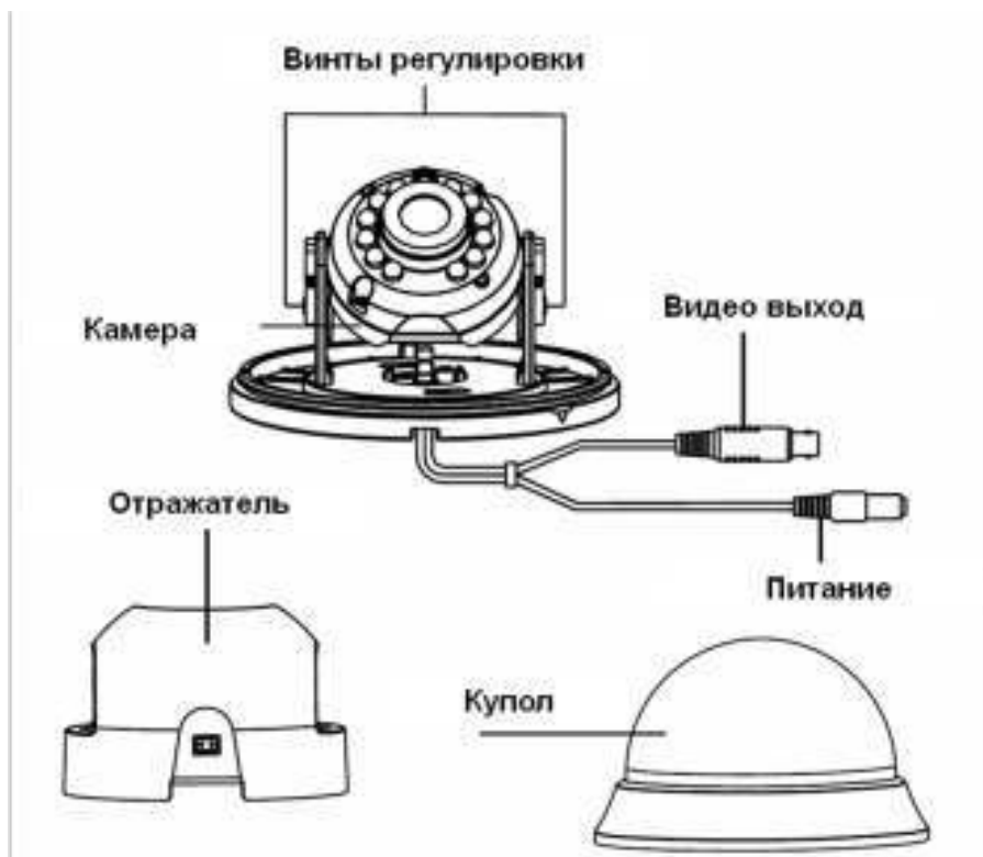
Рис. 4.1.1. Описание видеокамеры LTV CTB-710
