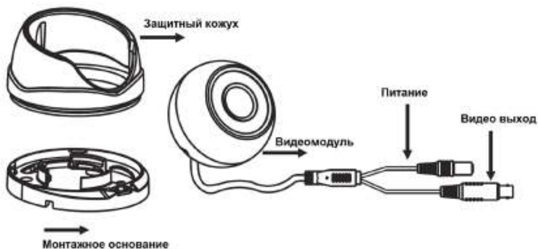
Рис. 3.1.1. Описание видеокамеры LTV CTB-910
