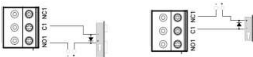
Рис.16. Подключение замков при использовании внешнего источника питания
