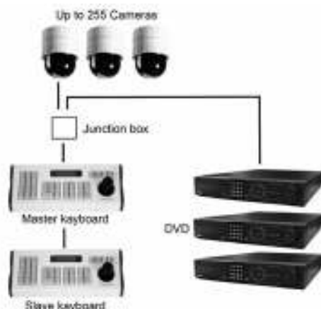
Типовая схема подключения STT-CN3R1
