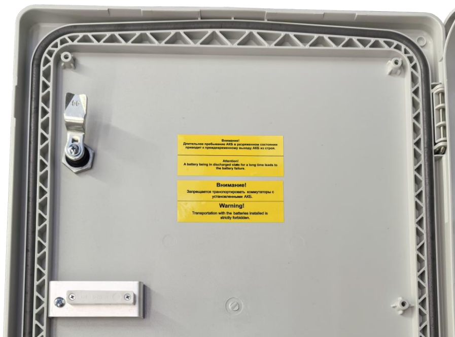
Рисунок 3.7.1 - Датчик вскрытия на крышке коммутатора
