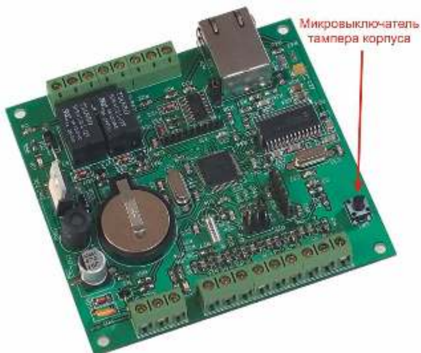
Рисунок 13. Микровыключатель тампера корпуса.
