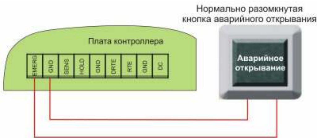
Рисунок 14. Подключение аварийной кнопки к одному контроллеру.
