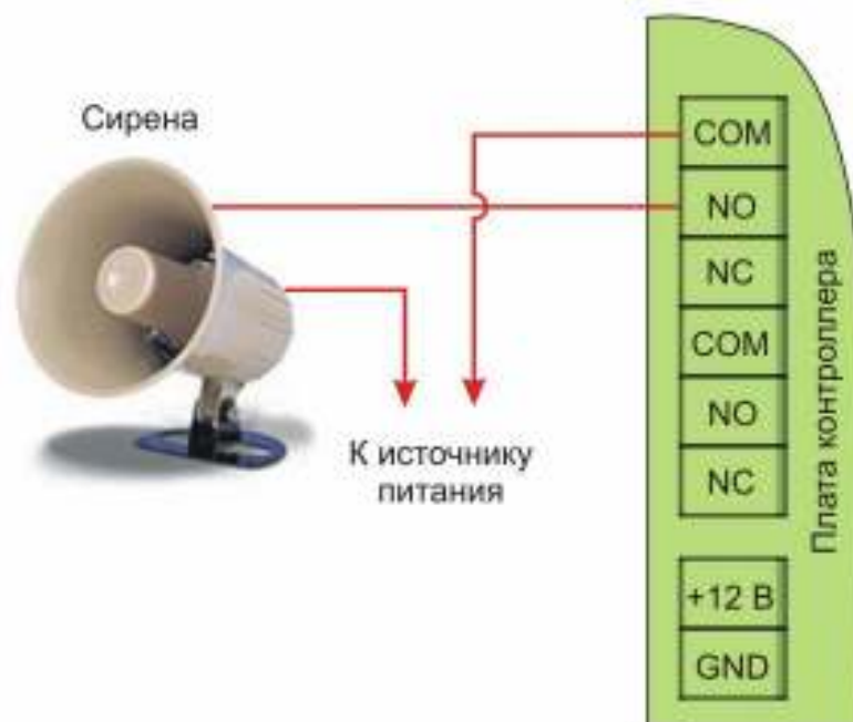
Рисунок 12. Подключение к дополнительному реле.
