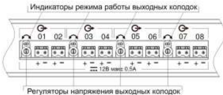
Рисунок 2 - описание коммутационных элементов преобразователя напряжения PN-V.8
