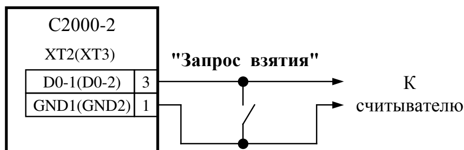
Рисунок 7 Подключение кнопки "Запрос взятия"
